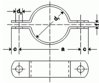
**Rohrschellen** Form A **ähnlich DIN 3567** mit abgerundeten Enden, 2-teilig, lieferbar in Werkstoff V2A und V4A, schwächere Ausführung.
